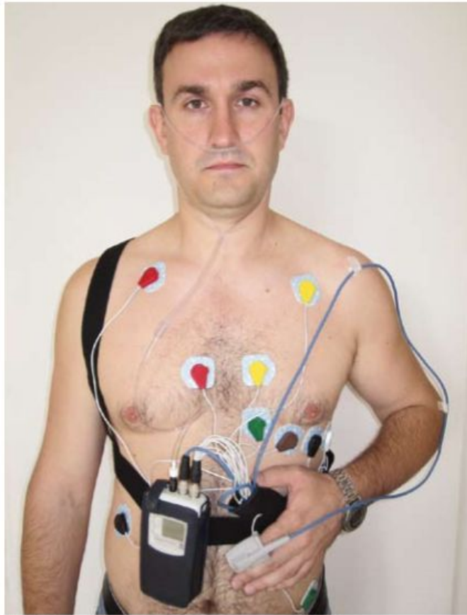
Рис 18. Холтеровский монитор «Кардиотехника-04-3Р (М)» компании «Инкарт» (Санкт-Петербург) с возможностью регистрации 12-каналов ЭКГ, пневмограммы, сатурации, воздушного потока и храпа.
