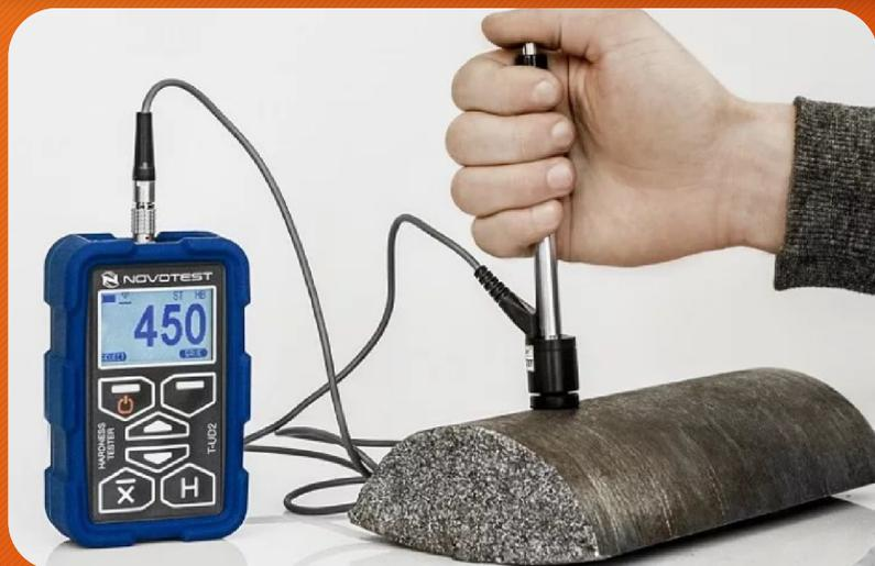
Качество термической обработки контролируют по твердости и отсутствию трещин в процессе длительного хранения.
