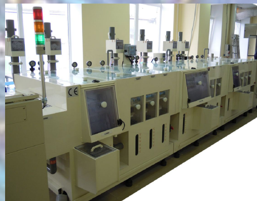
Линия подготовки поверхности печатных плат перед нанесением защитной паяльной маски
