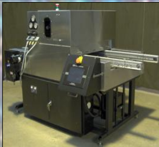
Установка нанесения жидкой защитной паяльной маски методом напыления
