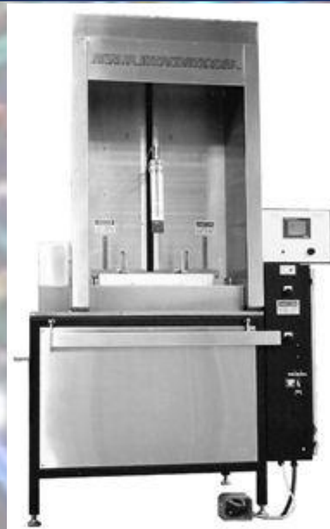
система крепления тонких и гибких печатных плат
