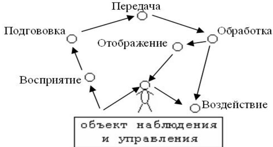
На этапе **подготовки информации** производятся такие операции, как **нормализация, аналого-цифровое преобразование, шифрование.**
