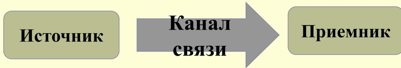
В любом процессе передачи или обмена информацией существуют ее *источник* и *приемник*, а сама информация передается по *каналу связи* с помощью сигналов: механических, электрических, тепловых ...
