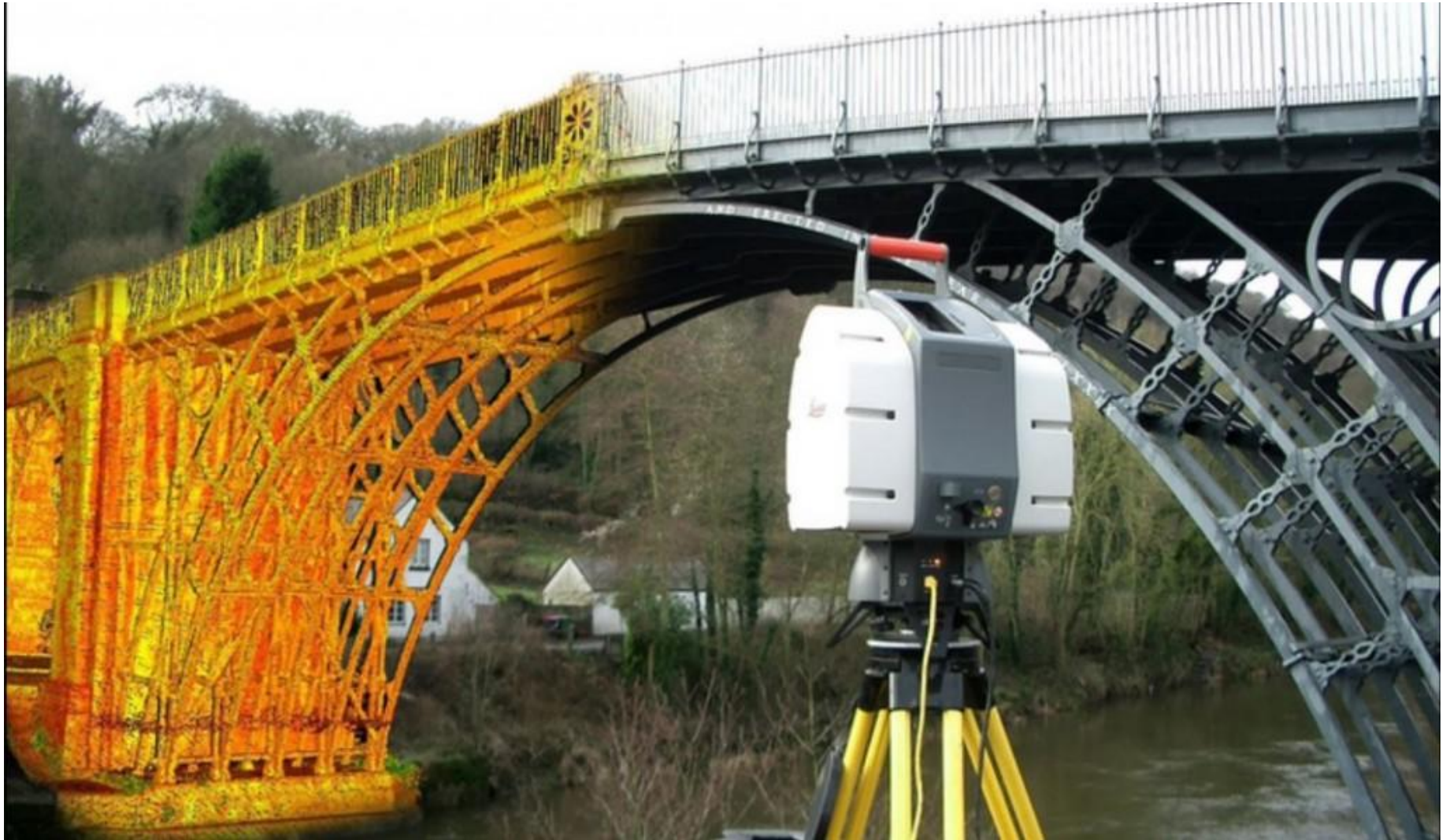
Рисунок 9 – Съёмка моста с использованием наземного лазерного сканера
