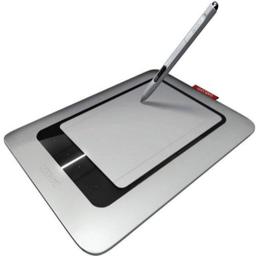
По технологии изготовления дигитайзеры делятся на два типа: электростатические (ЭС) и электромагнитные (ЭМ). В первом случае регистрируется локальное изменение электрического потенциала сетки под курсором. Во втором - курсор излучает электромагнитные волны, а сетка служит приемником.
