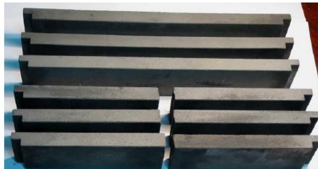
*Мишени из  $ZrB_2$  для магнетронного распыления в технологии ТВЭЛов с топливными таблетками  $UO_2$ , покрытых борным выгорающим поглотителем (для Росатома)*
