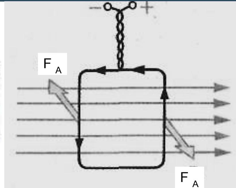
**Если поместить проволочную рамку, по которой протекает электрический ток, в магнитное поле, то в результате действия силы магнитного поля, рамка будет поворачиваться**
