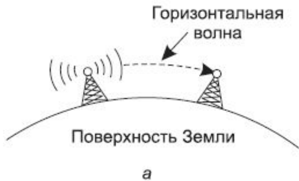
Рис. 2.10. Волны диапазонов VLF, LF и MF огибают неровности поверхности земли (а); волны диапазона HF отражаются от ионосферы (б)
