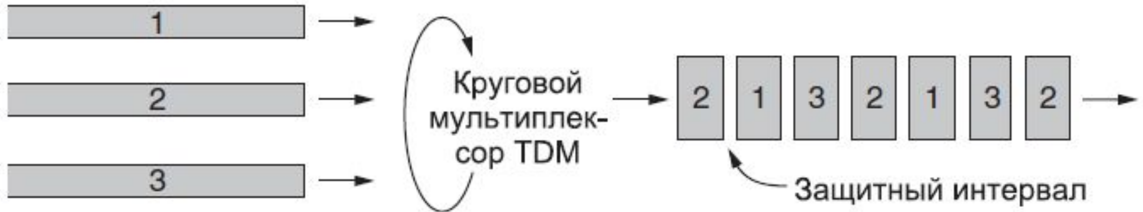
Рис. 2.23. Мультиплексирование с разделением времени (TDM)
