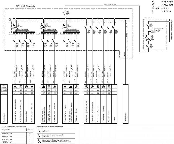
Допустина замена марки автонатов, дифференциальных автоматов при условии сохранения номинала и наличия комбинированного (теплового и электромагнитного) расцепителя: 930, рубильников при сохранении номинала
