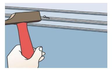
Это очень быстрый способ крепления, но, к сожалению, из-за неровностей поверхности не всегда подходит. Более распространенный и надежный способ — прикрепить кабельканал при помощи дюбельгвоздей, если стены бетонные или кирпичные, или обычными шурупами, когда деревянные. К гипсокартонным перегородкам или облицовке кабель-канал крепится при помощи специальных дюбелей-бабочек.
