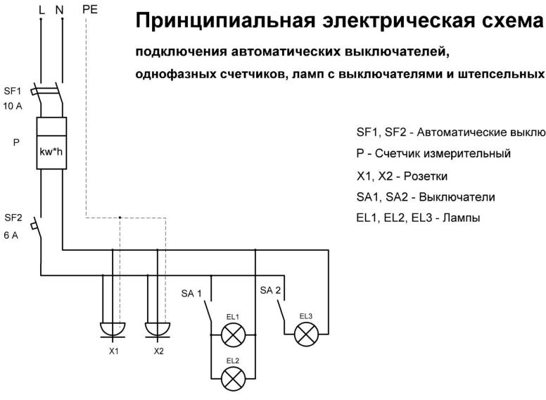
однофазных счетчиков, ламп с выключателями и штепсельных розеток
