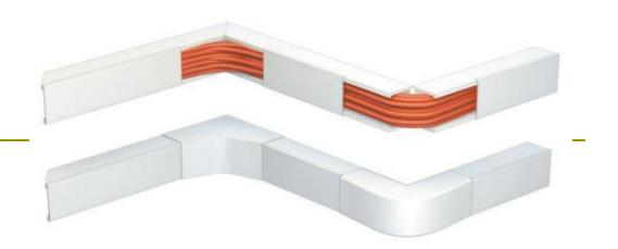
Аксессуары к кабель-каналу — это поворотные углы, внутренние или наружные, на 90° или плавные, торцевые заглушки, тройники, переходы под кожух другого сечения и т. д. Изгибы трассы данного защитного кожуха прикрываются наружными и внутренними углами. Можно обойтись и без них, просто надрезая и сгибая короб и крышку, но монтаж с аксессуарами намного быстрее и эстетичнее. Составив подробный чертеж, нужно сосчитать количество этих деталей, а также длину короба.
