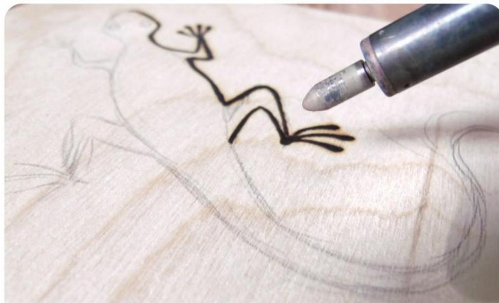
Чтобы получить тонкую линию, перо электровыжигателя следует передвигать быстро. Толстую линию получают при медленном движении пера. В конце линии перо надо быстро отрывать от рисунка. Вести перо следует без нажима. Рисунок сначала выжигают по внешнему контуру, а потом переходят к внутренним линиям
