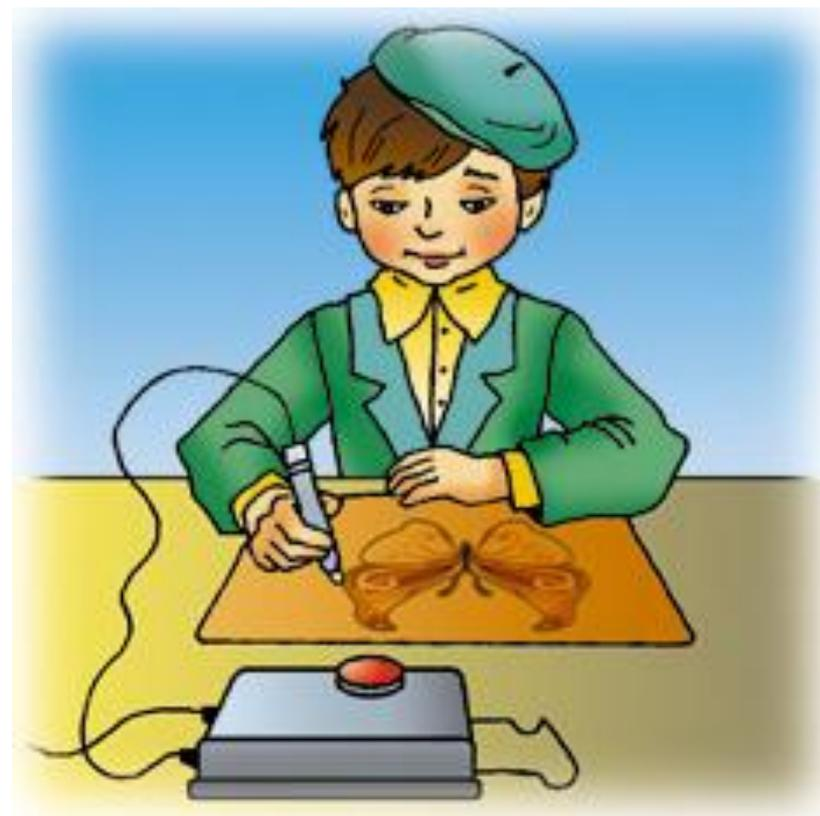
Для выжигания прибор включают в электросеть. Выжигание начинают после нагревания пера до темно-красного цвета. Нагревание пера регулируют ручкой регулятора от положения М (меньше) к положению Б (больше).
