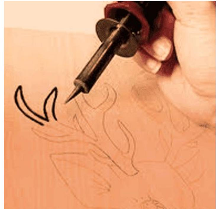
Через 10 - 15 мин работы электровыжигатель выключают на 2 - 3 мин для остывания.
