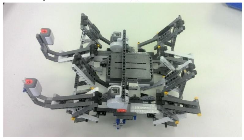
С задачей управления таким роботом очень хорошо справляется релейный регулятор на двух датчиках света, который был нами изучен ранее и применялся для управления двухмоторной тележкой. Далее перейдем в Trik Studio и повторим следование по линии на релейном регуляторе с двумя датчиками света
