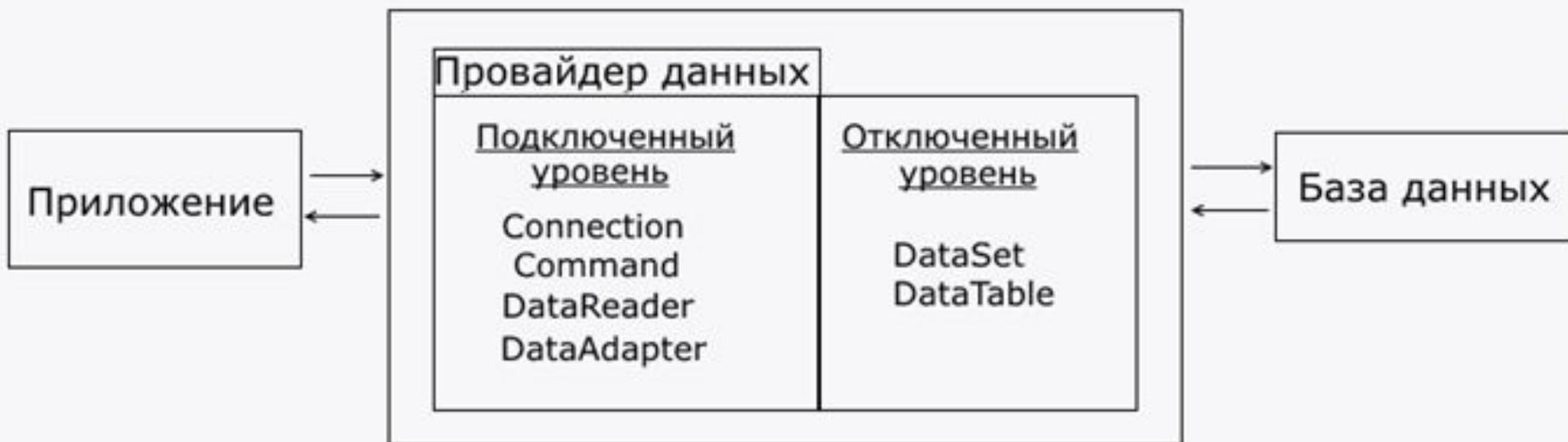
Функционально классы ADO.NET можно разбить на два уровня: **подключенный** и **отключенный**. Каждый провайдер данных .NET реализует свои версии объектов **Connection**, **Command**, **DataReader**, **DataAdapter** и ряда других, который составляют подключенный уровень. С помощью них устанавливается подключение к БД и выполняется с ней взаимодействие.
