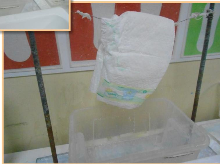
Подгузники вынимаем из раствора и подвешиваем на прищепках на 2 минуты (для стекания раствора). Это нужно для того, чтобы потом понять сколько впитал в себя впитывающий слой
