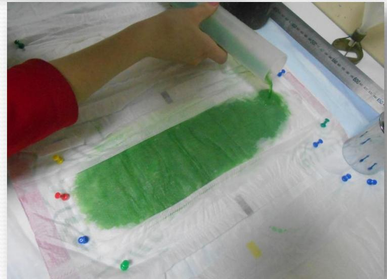
На ровной поверхности стола клеевым скотчем фиксируем впитывающий слой (Core-слой) подгузника. При помощи мерного цилиндра равномерно заливаем раствором. Объем в зависимости от типа полуфабриката
