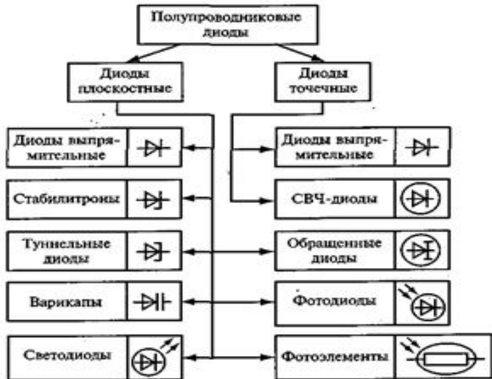
Рис. 2.32. Классификация и условное графическое обозначение полупроводниковых диодов
