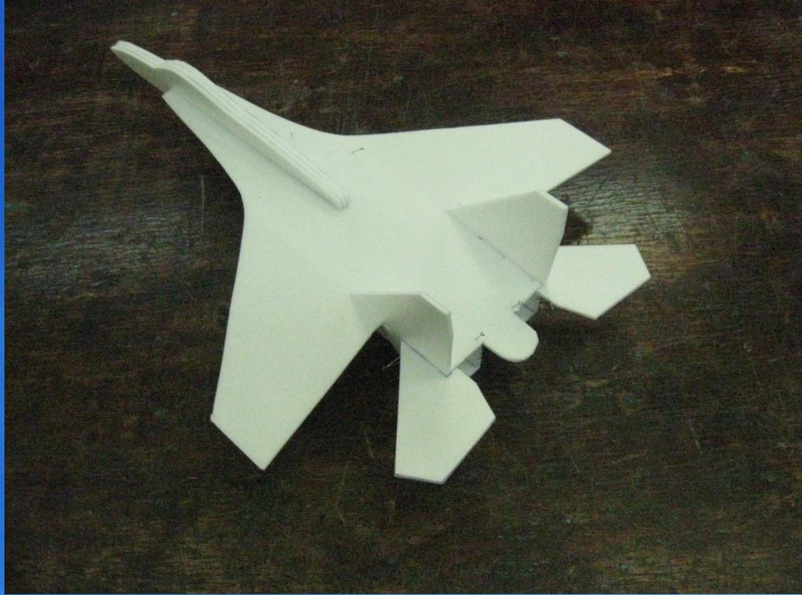
7. В хвостовой части фюзеляжа клеим стабилизатор.
