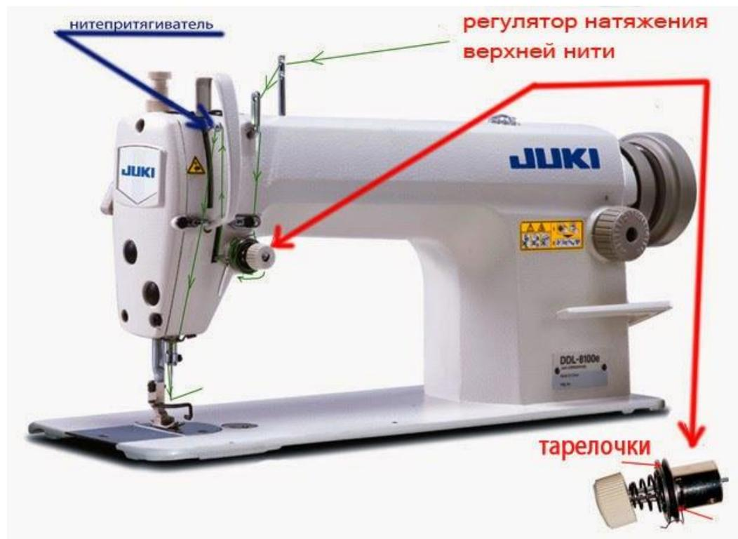
Чем большая цифра регулятора установлена напротив риски, тем больше будет натяжение верхней нитки.
