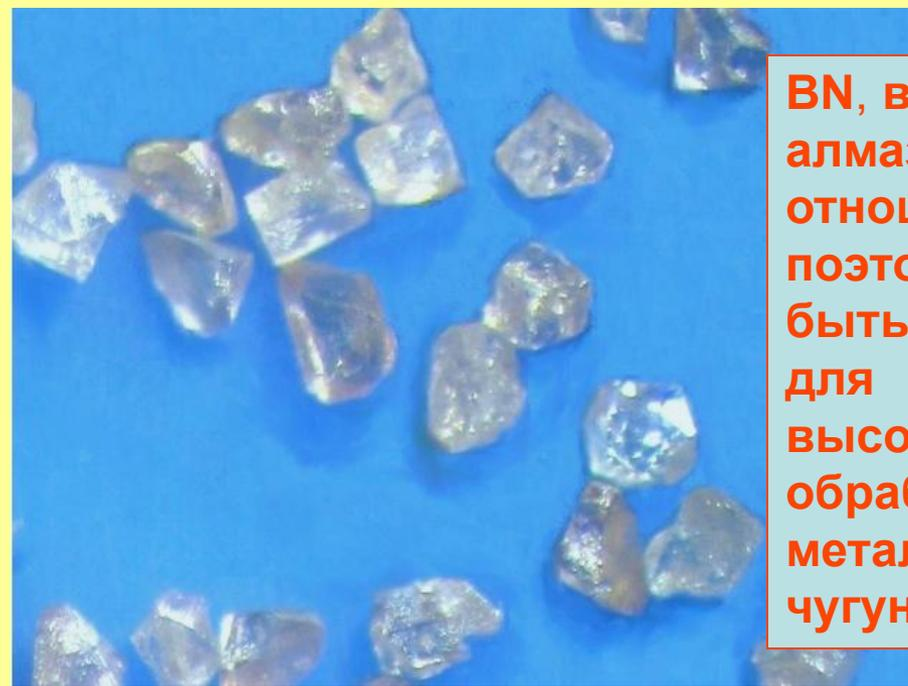
**BN, в отличие от алмаза, инертен по отношению к Fe и поэтому может быть использован для высокоскоростной обработки черных металлов (сталей и чугунов).**
