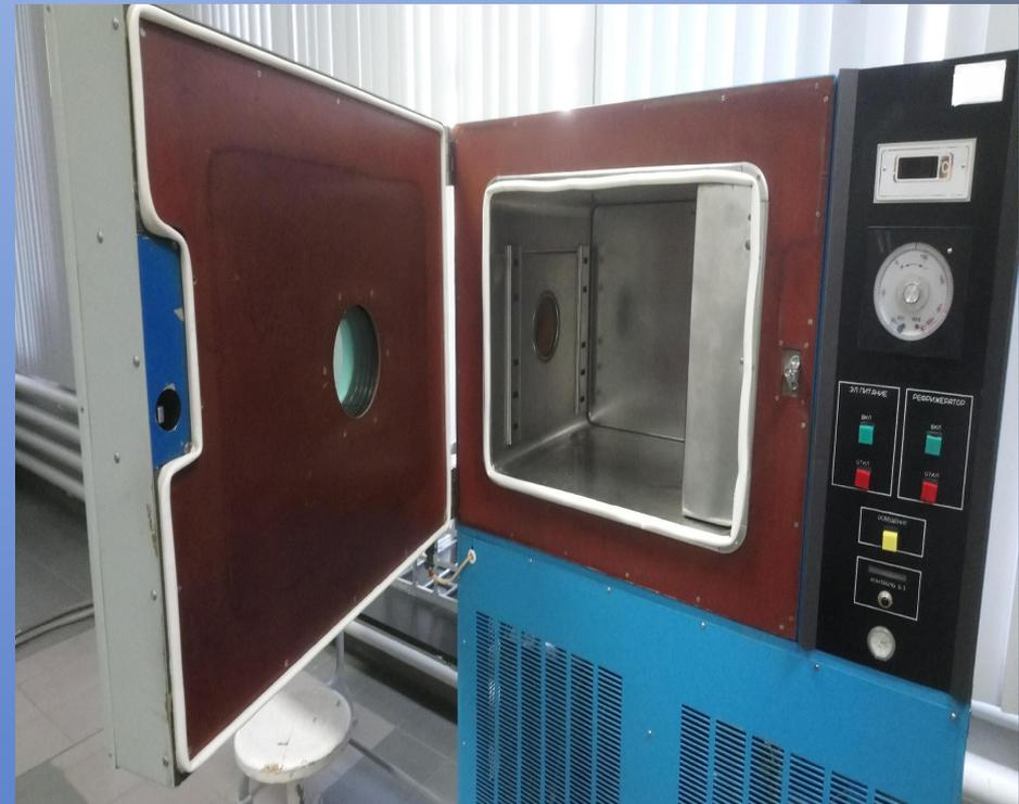
Применение прибора ТЕРМОДАТ для определения точности работы блока управления температурой камеры ТВТ-2.
