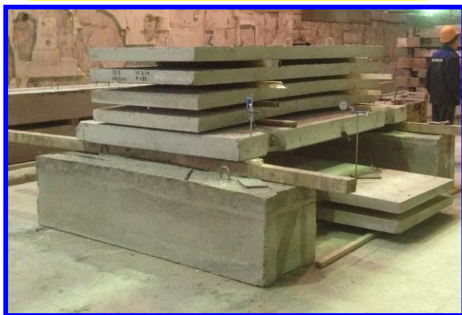
Контрольная нагрузка 3.8т – трещины отсутствуют
