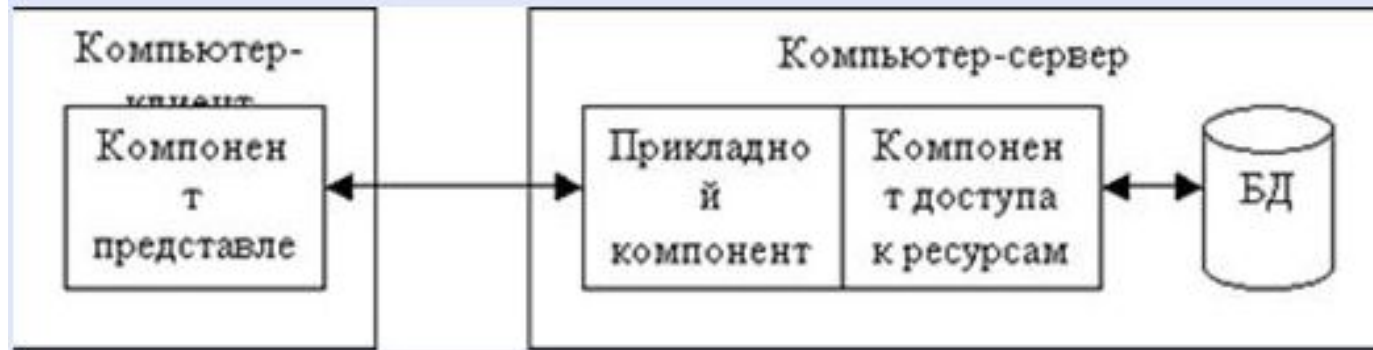
Рис. 14. DBS-модель сервера приложений
