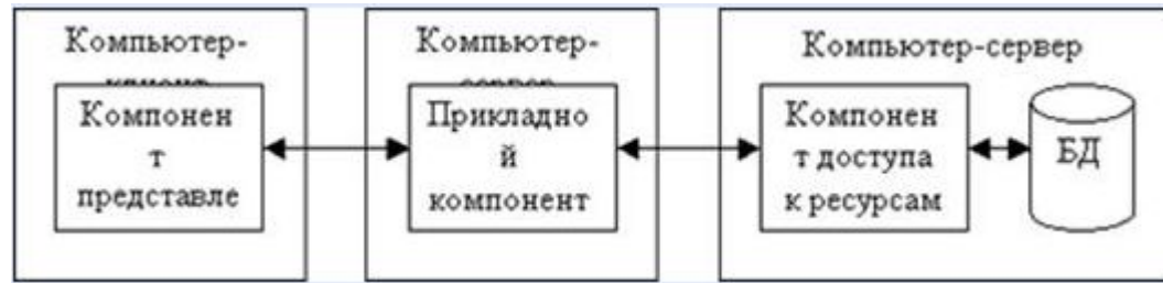
Рис. 15. AS-модель сервера приложений
