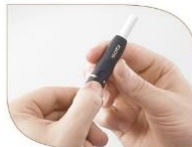
Нажмите и удерживайте Кнопку включения несколько секунд, пока индикатор не начнет мигать зеленым.
