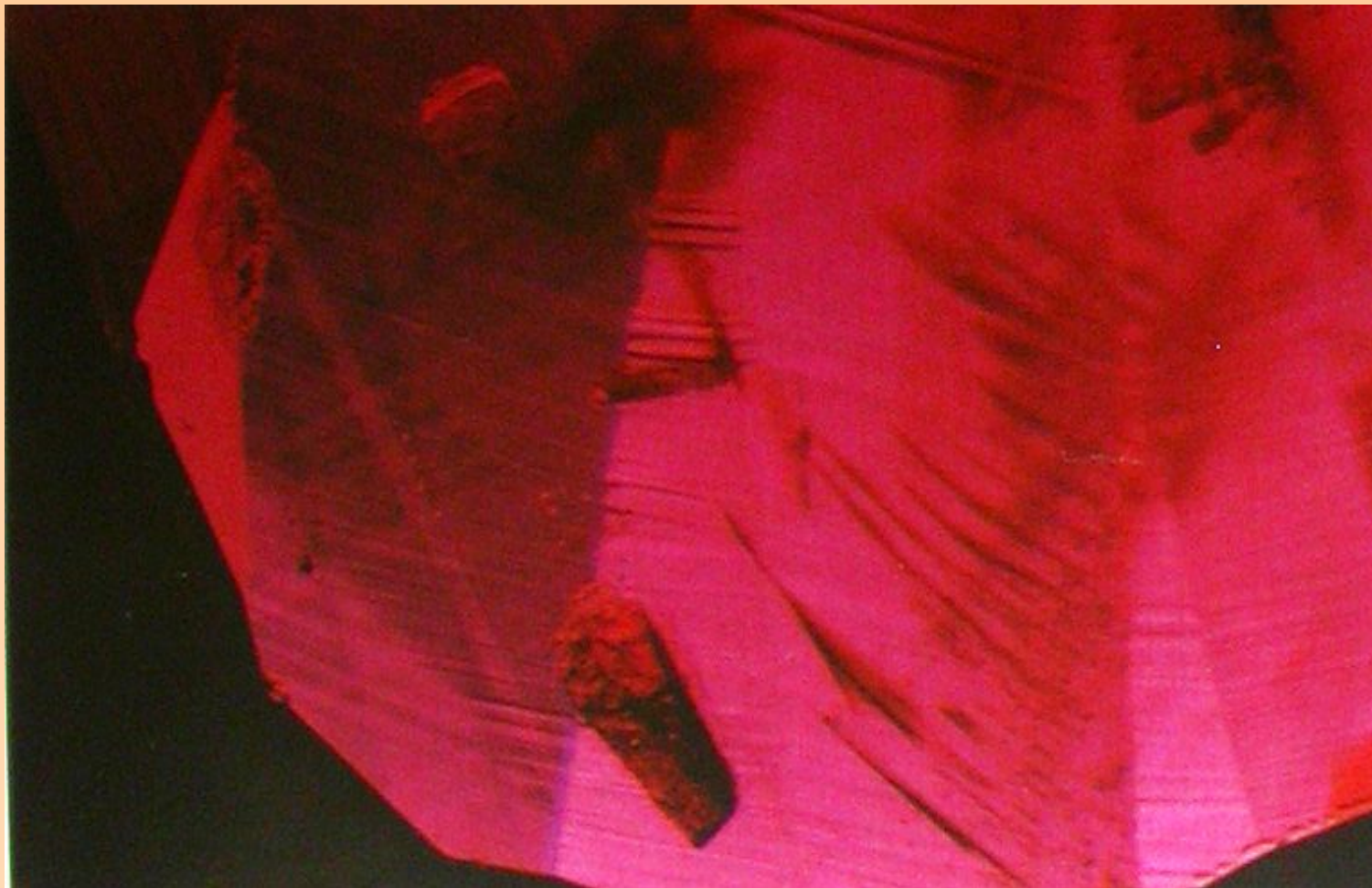
Сильно корродированный кристалл флогопита, пересекающий ламелли полисинтетического двойникования в рубине из Джегдаллека, Афганистан. Темное поле. 20 х.
