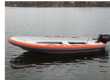
**НЕПОТОПИЯЕМОСТЬ (БЕЗОПАСНОСТЬ) ЛОДКИ** обеспечена двойной корпусной конструкцией. Запас плавучести при залипании или опрокидывании лодки составляет 350 кг. Высота надводного борта при аварийном повреждении наружного корпуса и грузоподъемности 250 кг-0,3 м. Благодаря комбинированным обводам корпуса, лодка имеет очень хорошую начальную устойчивость и прекрасные ходовые качества.
