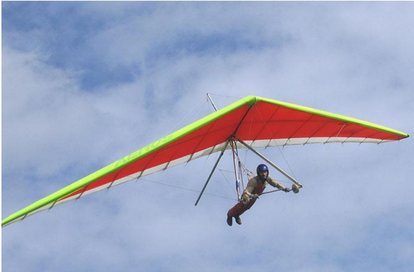
**Дельтаплан** - лёгкий безмоторный летательный аппарат с обтяжным каркасом, с подвесной системой и ручкой, за которую держится спортсмен.
