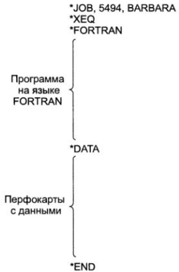
Схема работы с операционной системой FMS
