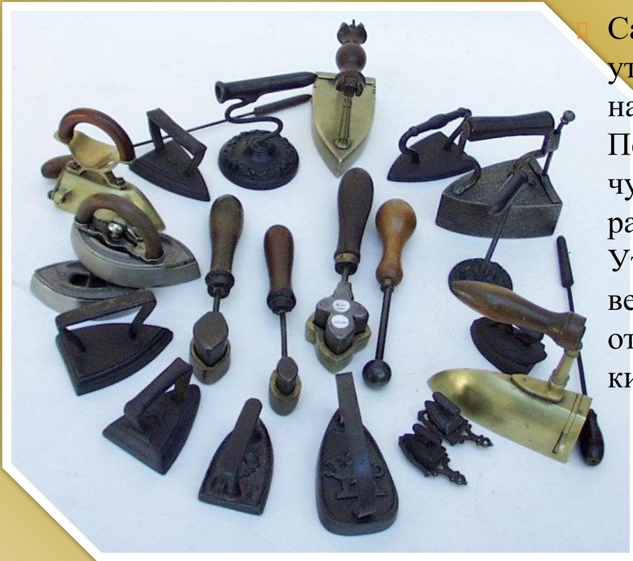
□ Самые простые утюги - нагревательные. Перед употреблением чугунные монолиты разогревали в печи. Утюги для ткани весили по разному - от одного до 10 килограммов.
