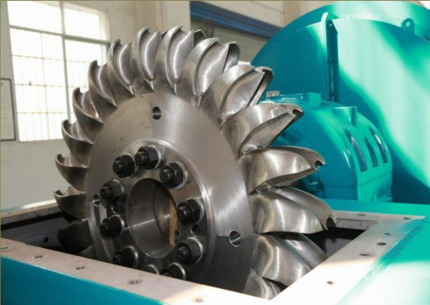
Ковшовая гидравлическая турбина - активная гидравлическая турбина, лопасти рабочего колеса которой имеют форму ковша
