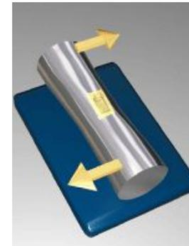
При деформации кручения одна пара, напротив лежащих датчиков вместе с поверхностью вала подвергается растяжению (сопротивление датчиков увеличивается), а другая пара — сжатию (сопротивление датчиков уменьшается). Это приводит к нарушению баланса мостика, на его выходе появляется сигнальное напряжение, пропорциональное величине момента на гребном валу.
