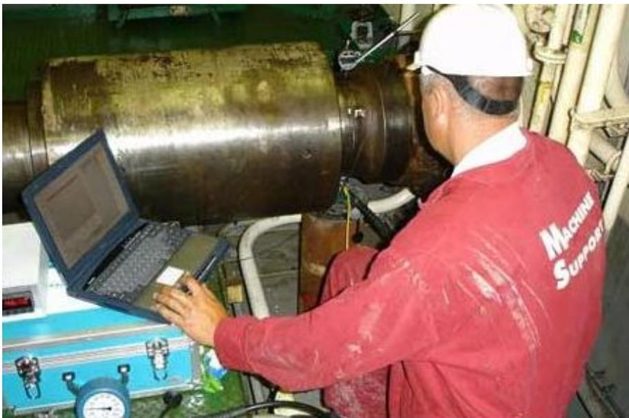
**Величина** этих напряжений пропорциональна действующему на вал моменту. **Направление наибольшего растяжения (сжатия)** поверхностного слоя гребного вала при деформации кручения **составляет угол 45 гр** к его осевой линии.
