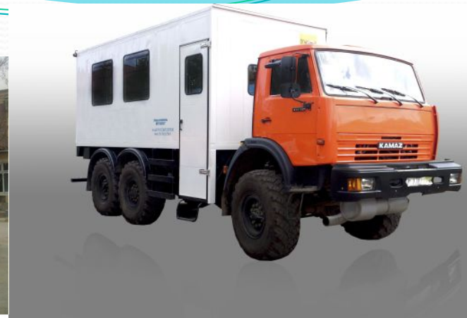
Вахтовый автобус на шасси КАМАЗ 43118 (6х6)
