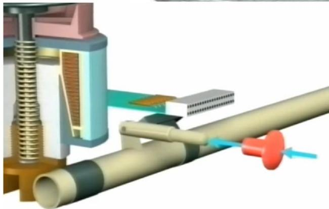
Выключатель отключается только с помощью подачи питания на катушке привода. Для отключения выключателя при отсутствии при отсутствии на подстанции питания цепей оперативного тока допускается инвентарный блок автономного включения. Ручное отключение выключателя при необходимости возможно путём механического воздействия на кнопку ручного отключения.
