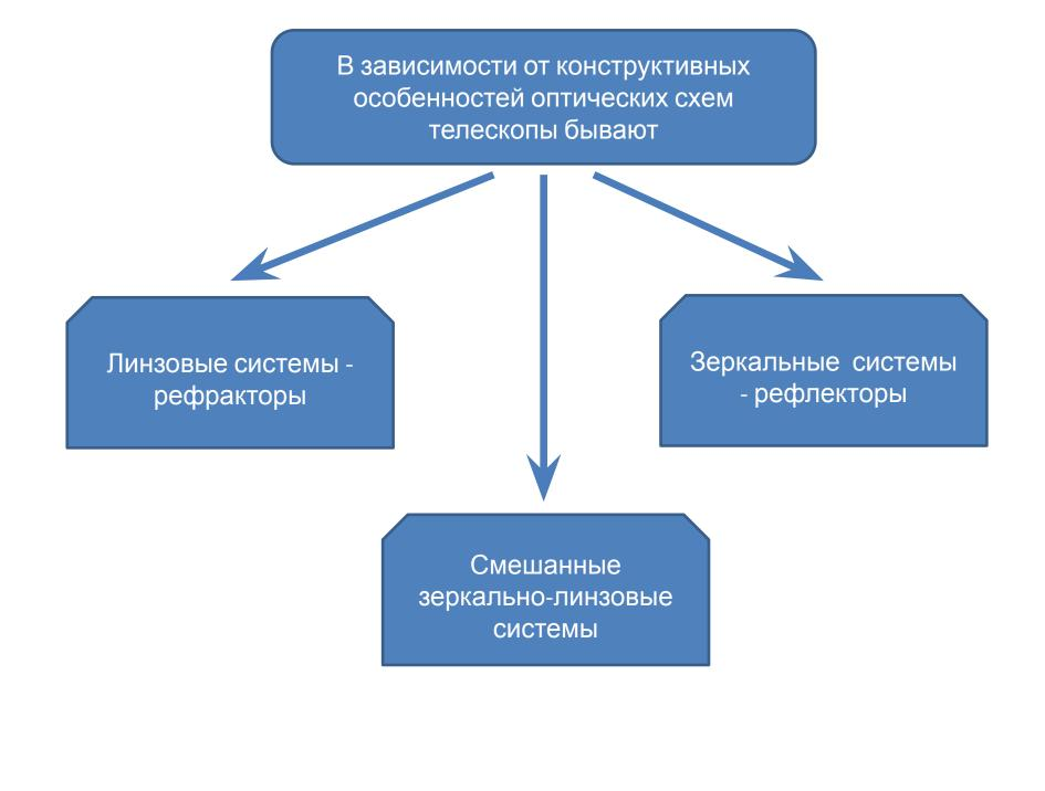
Рефрактор — оптический телескоп, в котором для собирания света используется система линз, называемая объективом. Работа таких телескопов обусловлена явлением рефракции (преломления)
