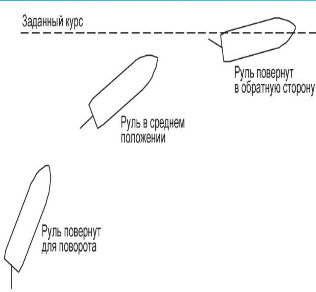
Режим RATE (пропорциональный) предназначен для судов с замедленным откликом на поворот руля, а также для тех судов, которые еще некоторое время продолжают поворот после возврата руля в среднее положение.
