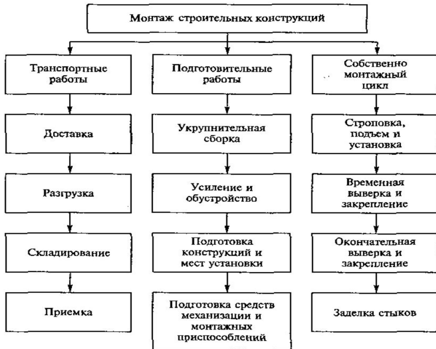
Схема технологического процесса монтажа строительных конструкций
