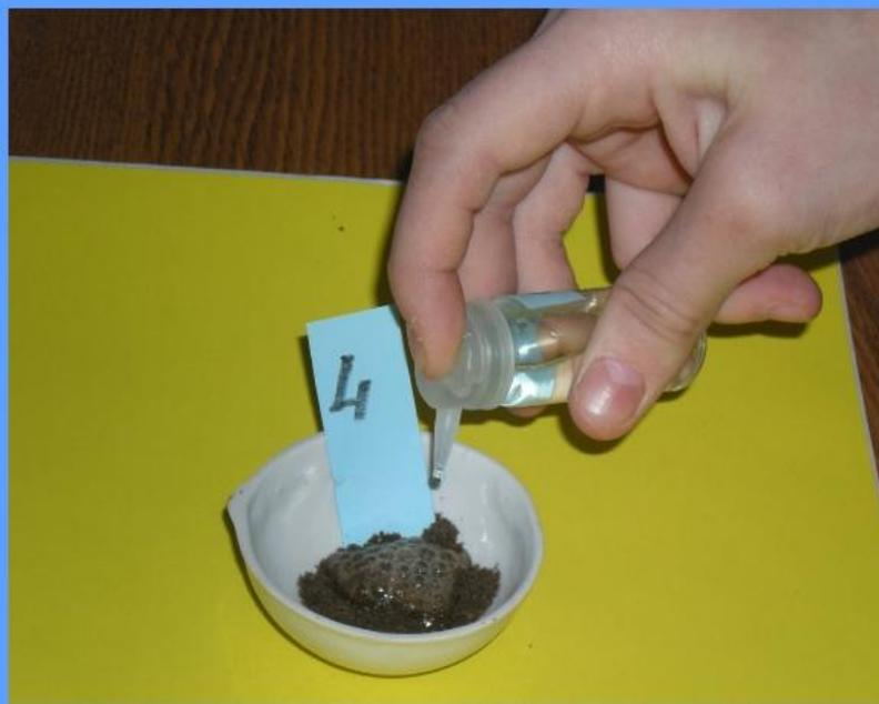
**Качественное определение хлорид-ионов.** К 5 мл фильтрата, помещенного в пробирку, прибавляют несколько капель 10% раствора азотной кислоты и по каплям 0,1 М раствор нитрата серебра. Образующийся осадок в виде белых хлопьев указывает на присутствие хлоридов в количестве десятых долей процента и более. При содержании сотых и тысячных долей процента хлоридов осадка не выпадает, но раствор мутнеет.
