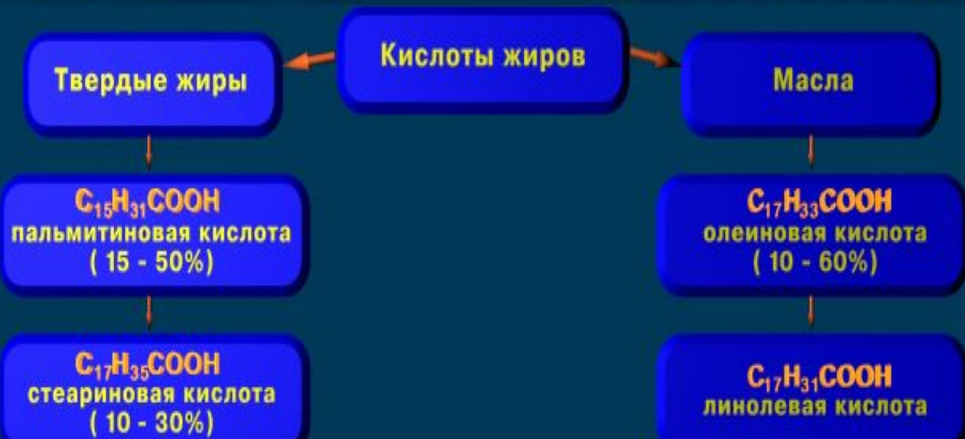
По агрегатному состоянию жиры подразделяются на твердые и жидкие, которые еще называют маслами. В состав твердых жиров входят, в основном, предельные кислоты, в состав жидких - непредельные. Из предельных кислот наиболее часто встречается пальмитиновая кислота ( $C_{15}H_{31}COOH$ ), из непредельных - олеиновая ( $C_{17}H_{33}COOH$ ).
