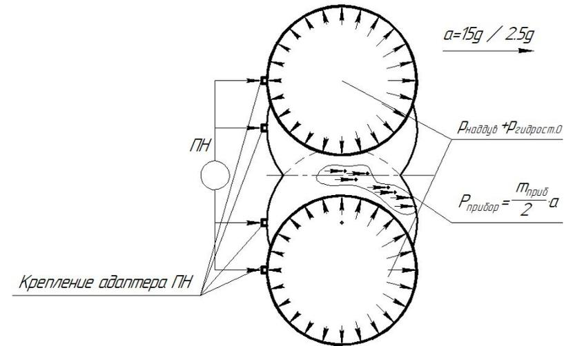
Схема модели для исследования, вид сбоку
