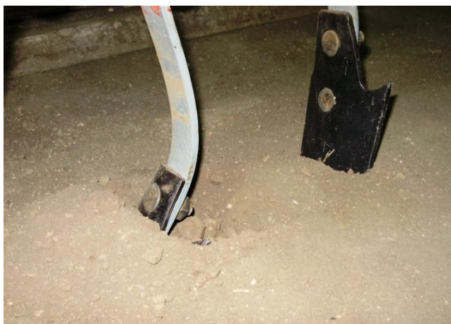
Вхождение рабочего лезвия в почву
