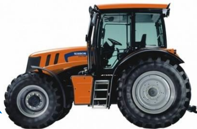
Трактор АТМ 3180М 3-го тягового класса
