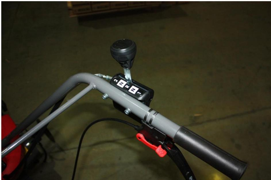
Расположение рычага переключения передач на рукоятке оператора. Эргономичная форма рычага и ручки повышают удобство оператора при работе.
