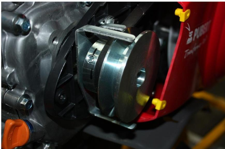
Привод фронтального навесного оборудования позволяет использовать широкую гамму навесного оборудования: снежный отвал, снегоотбрасыватель, щетку, роторную косилку, газонокосилку. Благодаря этому вы можете работать с мотоблоком **Pubert** круглый
