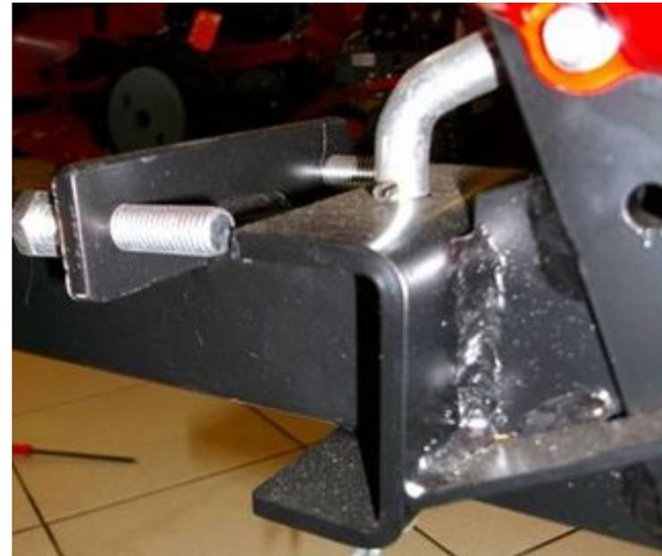
Для повышения надежности конструкции мотоблока, усиленное гнездо крепления навесного оборудования выполнено из более толстого металла. Это позволяет выполнять работу в более тяжелых условиях.
