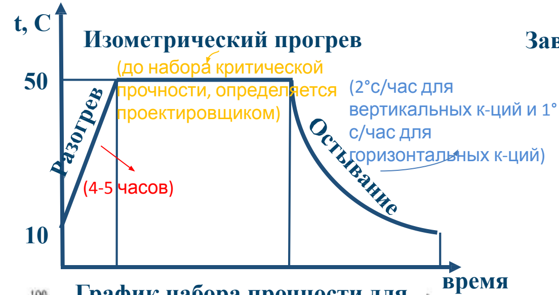
График набора прочности для бетона марки В25
