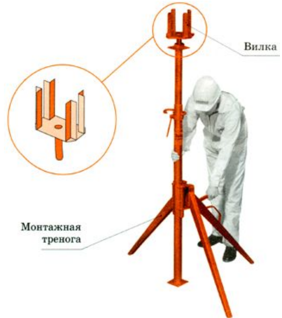
Закрепление опорной стойки
