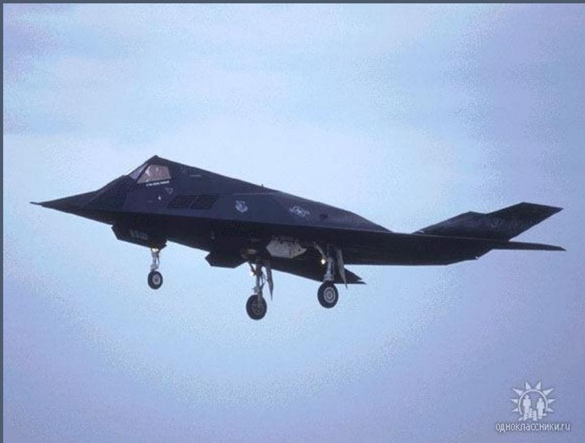
Локхид F-117 — одноместный дозвуковой тактический малозаметный ударный самолет, предназначенный для скрытного проникновения через систему ПВО противника и атак стратегически важных наземных объектов военной инфраструктуры (ракетные базы, аэродромы, центры управления и связи и т. п.), для поиска и уничтожения несущих боевое дежурство в воздухе самолётов
