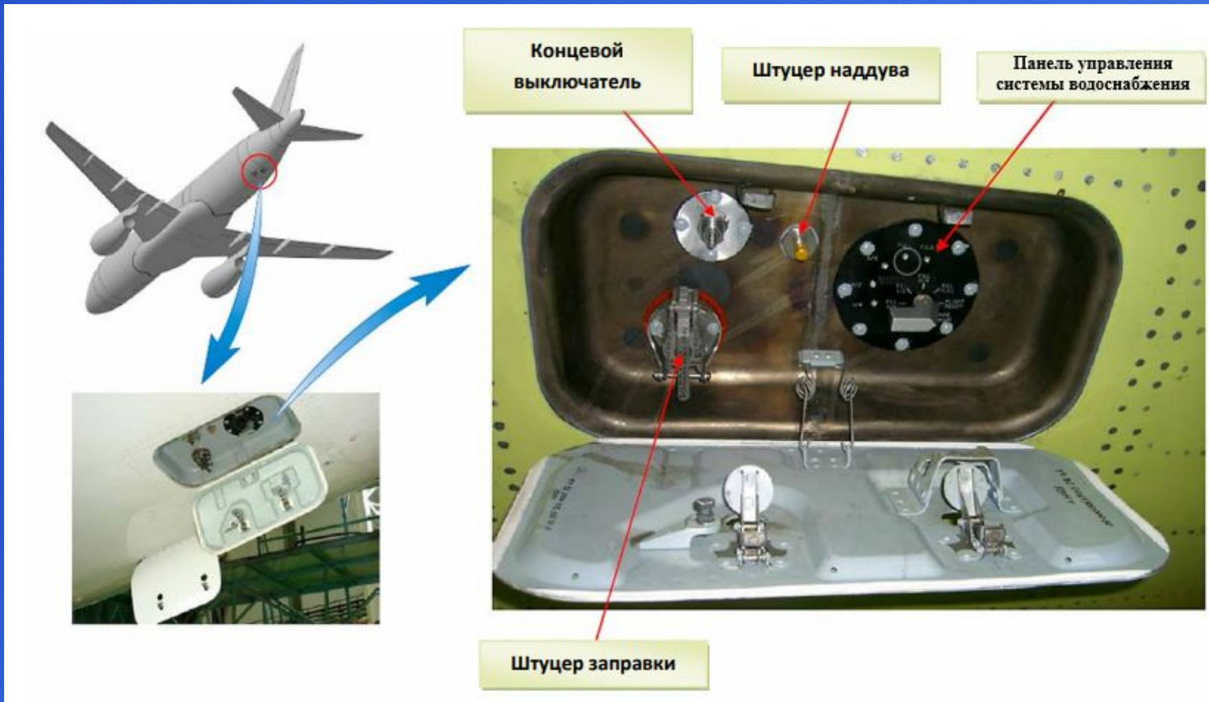
Панель наземного обслуживания системы водоснабжения
