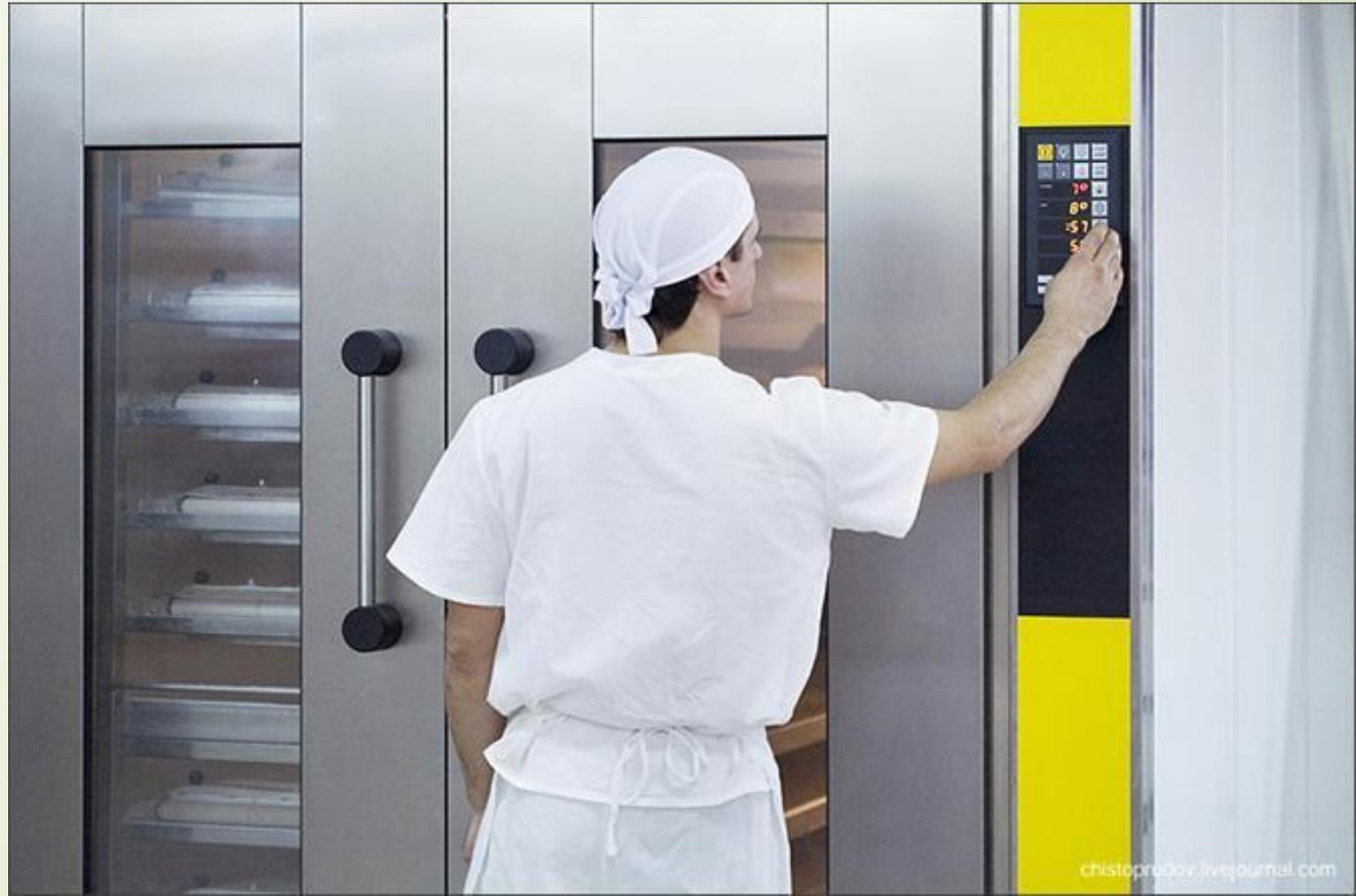
Из-за высокой влажности и температуры внутри растойки, тест насыщается влагой и раздувается за счет роста дрожжей.
