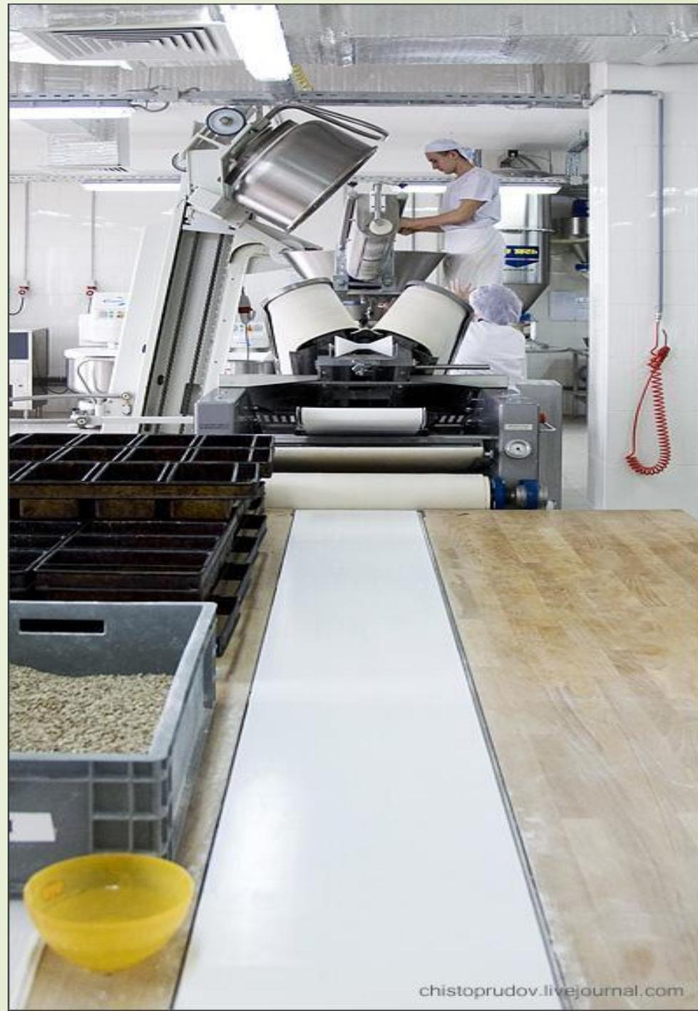
За счет разной скорости движения верхних лент транспортера заготовка медленно катится вверх и, закручиваясь, приобретает круглую форму. На выходе получается круглый кусок теста. Если подключить нижний транспортер, то тесто закатается в цилиндрическую форму.
