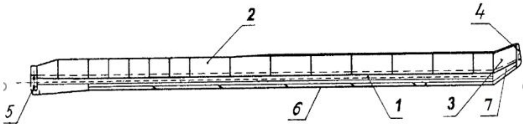
1- Носовая часть (ЛОИЖЕРОН); 2- Хвостовой отсек; 3- Законцовка в сборе; 4- Обтекатель концевой; 5- Кронштейн; 6- Оковка из титана; 7- Носовая часть стреловидной законцовки
