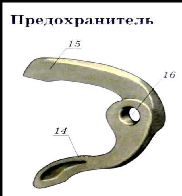
Чтобы предупредить излом нижнего плеча от действия инерционной нагрузки, в нем предусматривают углубления 6, уменьшающие его массу. Предохранитель делают штампованным и литым. Литой вариант предохранителя изготавливается из стали, имеющей высокий предел выносливости.
