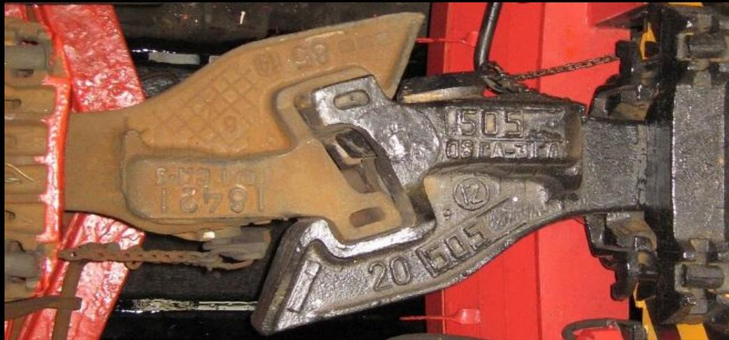
Механические автосцепки применяются для сцепления грузовых и пассажирских вагонов общего назначения; при этом меж вагонные коммуникации соединяются вручную. Унифицированные автосцепки устанавливаются на специальном подвижном составе: вагонах метрополитенов, некоторых типах зарубежных электро- и дизель-поездов и др.
