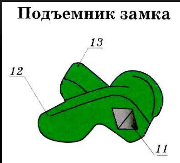
Широкий палец 13 поднимает предохранитель и уводит замок, а узкий палец 12 взаимодействует с расцепным углом замкодержателя. Отверстие 11 предназначено для квадратной части стержня валика подъемника. Буртик препятствует западанию подъемника в овальное отверстие замка. Углубление предусмотрено для опоры подъемника на прилив в кармане корпуса.
