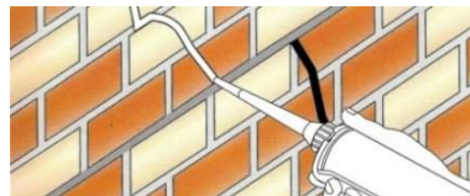
д – инъектирование трещин)
