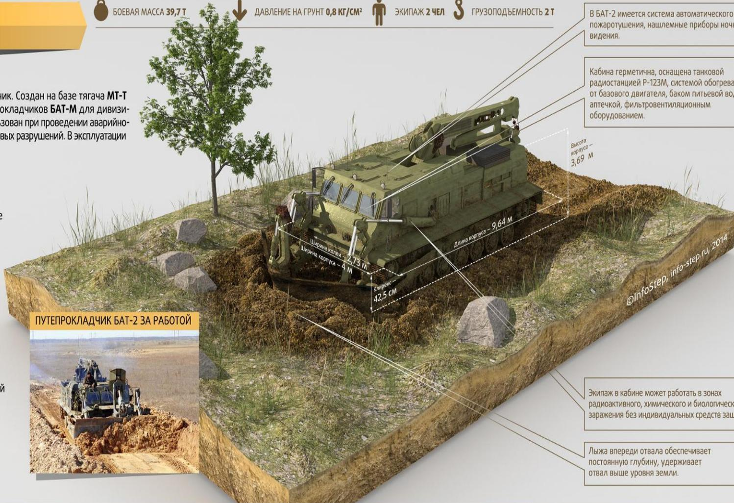
В БАТ-2 имеется система автоматического пожаротушения, нацеленные приборы ночного видения.
