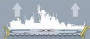
Спереди и сзади корабля установлены 2 эластичные высокопрочные «юбки». При опущенных «юбках» под днище вентиляторы нагнетают воздух, и корабль приподнимается над водой до осадки в 1 метр
