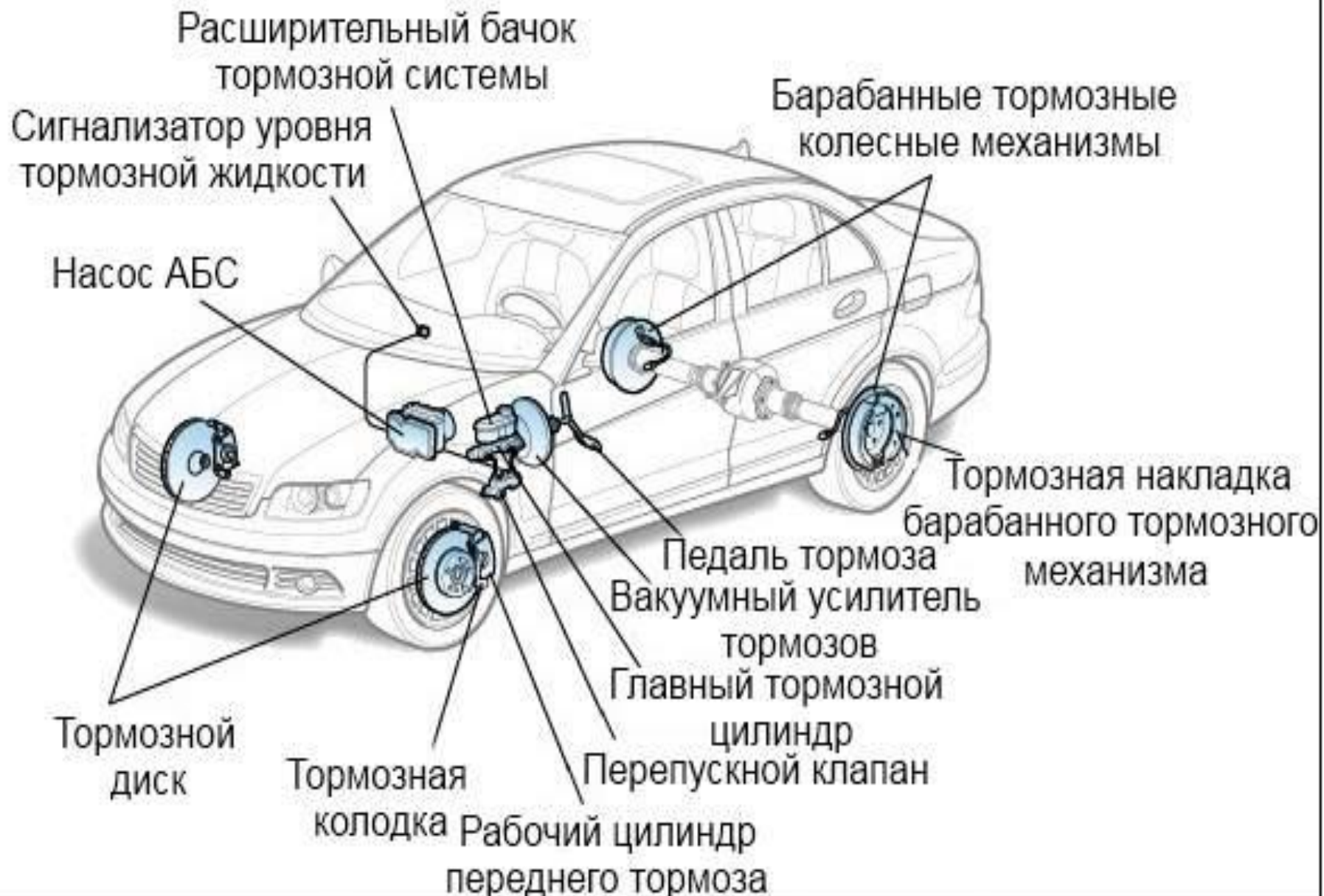
Устройство современной тормозной системы автомобиля
