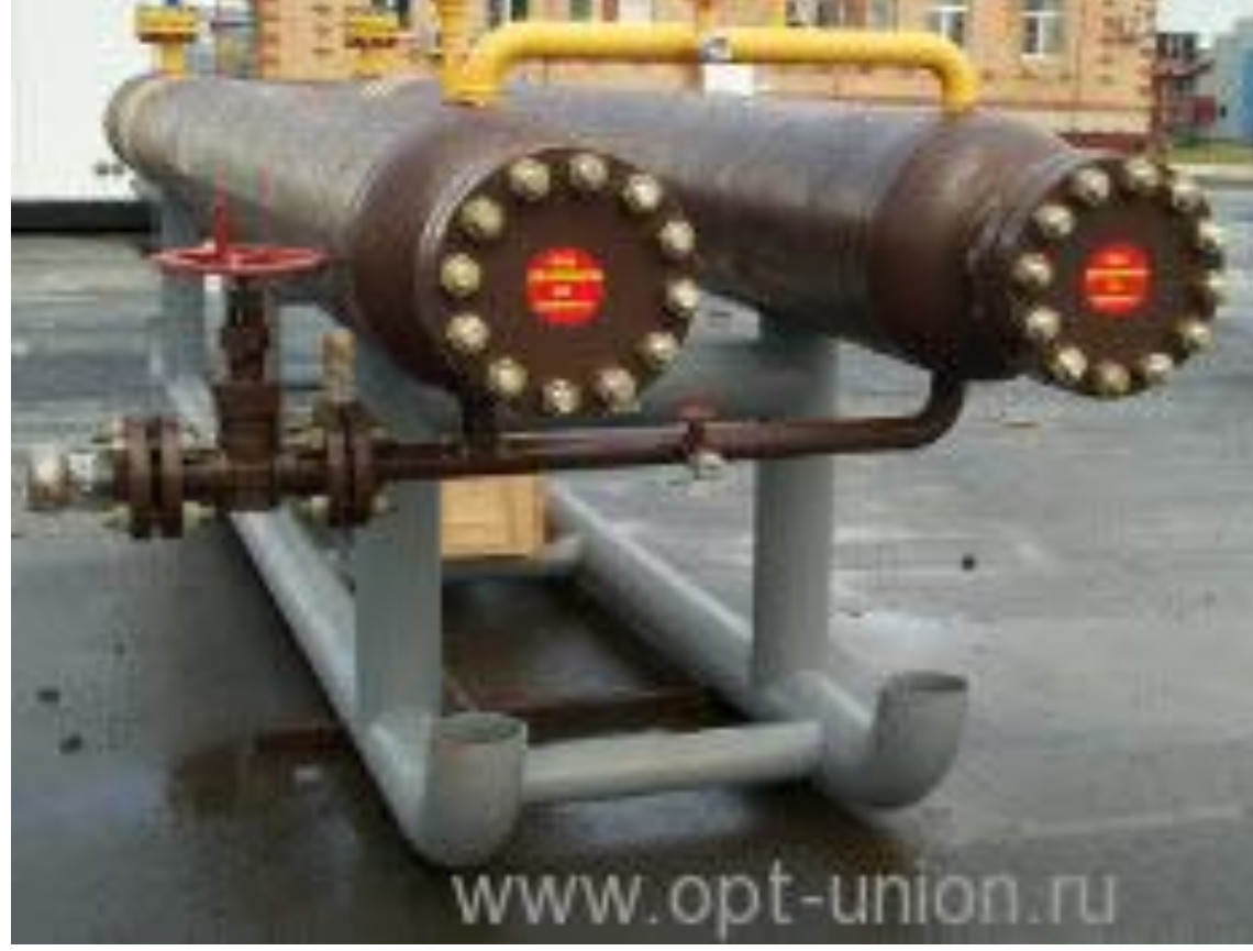
Рис. 4.3 Блок ввода метанола БВМ предназначен для дозированной подачи метанола в шлейф добывающих газовых и газоконденсатных скважин, в затрубное пространство нефтяных скважин или в газопровод.
