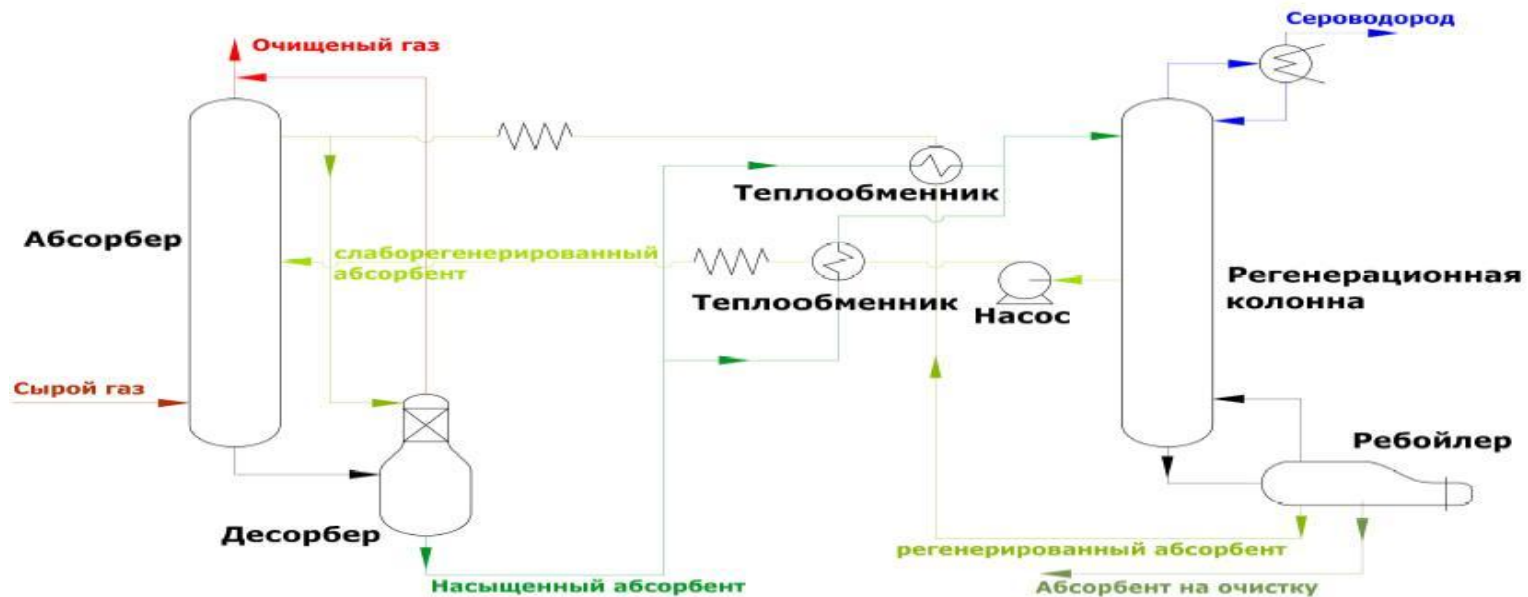
Типовая схема установки очистки газа от сероводорода
